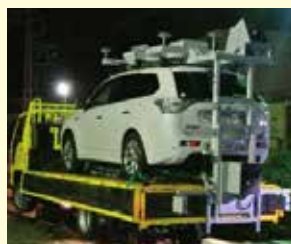
レーザースキャナを搭載した計測車両を軌陸車に載せ、3次元点群データを取得しています
