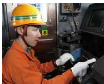
車両を制御する運転台の点検
