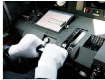
運転士の体調が急変したときにも安全を確保するため、ハンドルから手が離れると自動的に非常ブレーキがかかる装置を全編成に導入しています。
