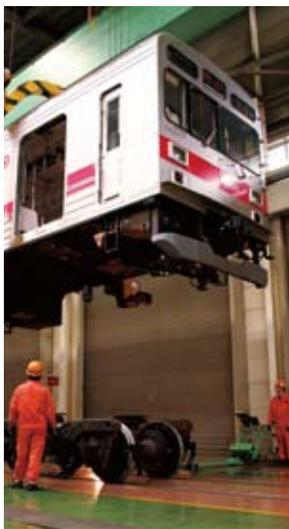
元住吉、長津田、雪が谷大塚にある検車区で、定期的に点検しています。また、恩田駅近くにある長津田車両工場では、4年に一度、車両を分解して検査・メンテナンスを行います。機器の異常の有無やブレーキの効き具合、車軸・連結器の探傷試験、車輪の摩耗具合など走行に関するすべてを検査します。
