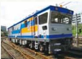
レールに超音波を当てて、外見では分からないレール内部に存在する傷を探し出し、レール折損などの事故を未然に防ぎます。
