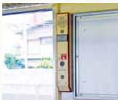
具合の悪いお客さまや車内の異常を乗務員に知らせる装置で、車両連結部付近や窓の横、車いすスペースに設置しています(位置は車両により異なります)。
