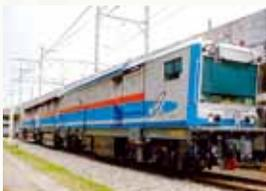
レール表面の凹凸を削って滑らかにします。レールと車輪の接点から発生する騒音や振動も低減します。
