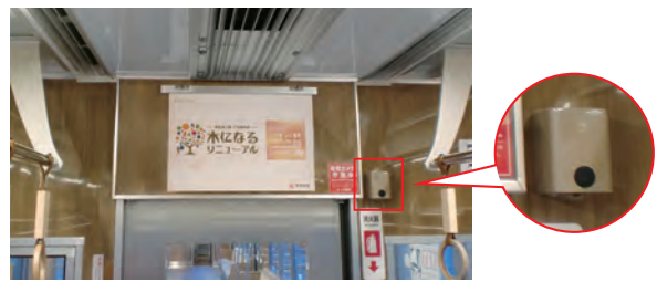
1000系に搭載した車両内防犯カメラ
