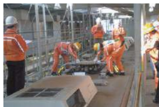
〈車両部門での技能競技会の一例〉架線から電気を集めるパンタグラフの保守検査にて、作業の安全性や正確性をチームごとに競い合います。
