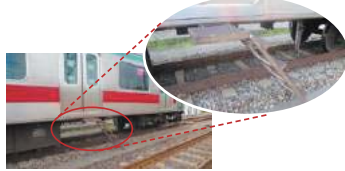
〈田園都市線5000系の側面非常梯子〉側面のドアから避難する際は、車両の床下に設置している側面非常梯子を使用します。
