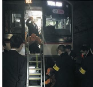
実際の地下区間で列車を緊急停車させ、避難誘導で使用する正面非常梯子を設置している様子
