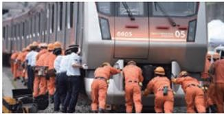
車軸を損傷した車両に搬送器具を取り付けて、移動させます
