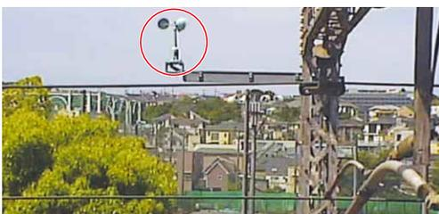
東急線沿線に設置した風速計
